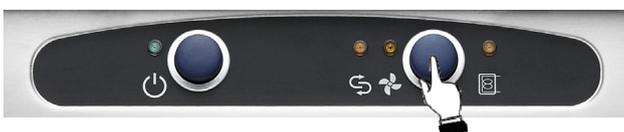
Bei ausgeschalteter Maschine und vollem Waschtank die Taste drücken
