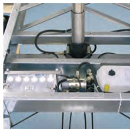
6 Elektrohydraulik mit Batterie
