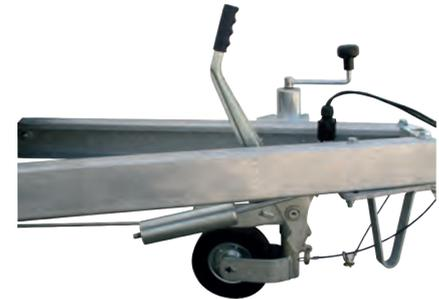
Hier muss der Handbremshebel bis in die senkrechte Position gezogen werden, dadurch wird der Federzylinder am Bremsgestänge gespannt.
