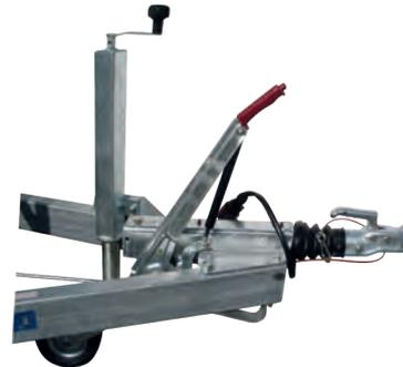
Bei dieser Ausführung muss der Handbremshebel nur über den Tötppunkt gezogen werden, die Gasfeder spannt die Bremse und hält sie gespannt.
