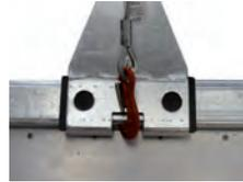
Vor der Inbetriebnahme der Zugseilwinde ist der Windenstand dringend in die entsprechende Fahrtrichtungs-Flucht zum Pkw-Abschlepphaken zu verschieben. Ein Schräg- oder Diagonal-Zug ist dringend zu vermeiden, da es dadurch zu Beschädigungen bzw. Verformungen am Windenstand kommen kann.
