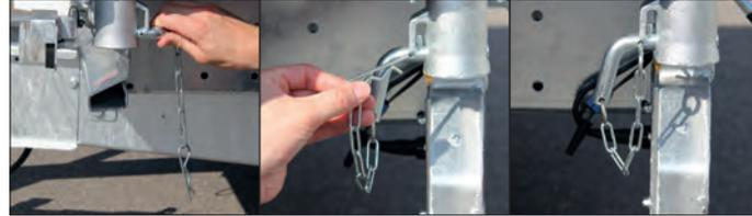
**Bild 2:** Sicherungsbolzen (nur diagonal umsteckbar)
