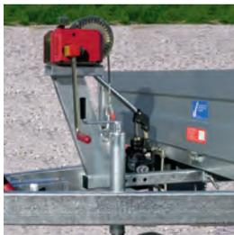
8 Verstellb. Windenstand mit Winde
