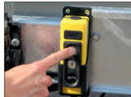
**Bild 8:** Taster zum Heben
