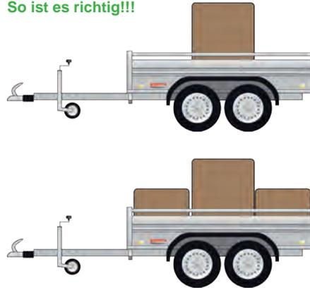
Die schweren Teile der Zuladung möglichst im Bereich der Achse laden. Die Last gleichmäßig verteilen.
