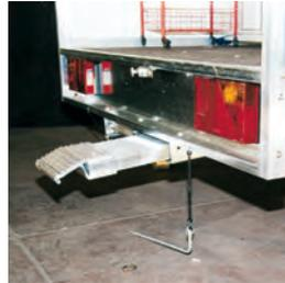
85 Einschlebbare Alu-Auffahrschiene mit Führungskasten
