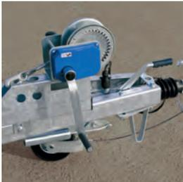
21 Zugseilwinde, Standard
