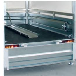
67 Motorrad-Standschiene und -Auffahrschiene an Bordwand montiert
