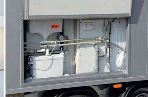
△ Serviceklappe außen zur Wartung der Zu- und Abläufe
